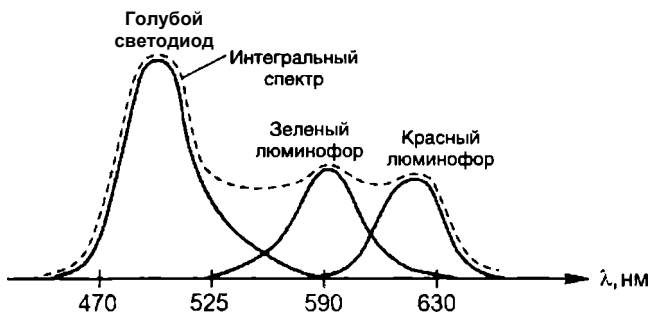
Рис. 2.137. Более сложная схема получения белого света с помощью голубого светодиода
