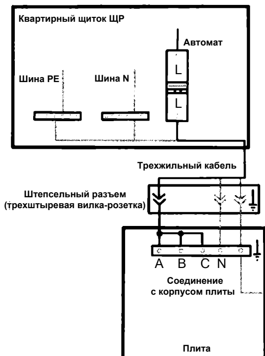
Рис. 2.104. Схема подключения трехфазной плиты в однофазную сеть
