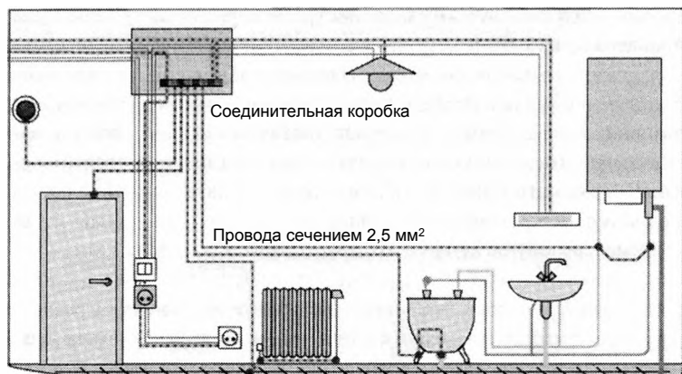
Рис. 2.40. Система уравнивания потенциалов
