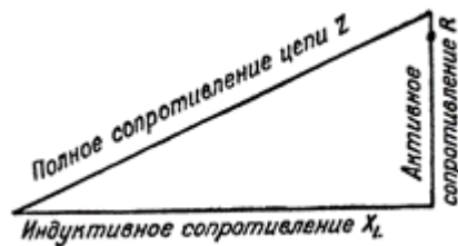
Рисунок 1. Определение полного сопротивления цепи, содержащей индуктивное и активное сопротивление
