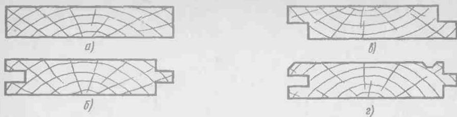
Рис. 35. Основные профили по сечению фрезерованных заготовок: а — с плоским профилем, б — в паз и гребень, в — в четверть, г — в паз и гребень с фигурным профилем
